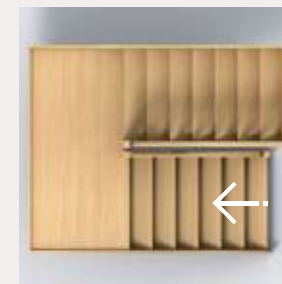
AVEC 2 RAMPES ET PALIER
